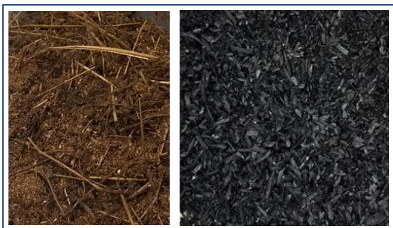
Figur 3. Hästgödsel (spån som strömmaterial) och biokol – två fiber-material som tillsätts i reaktorförsök med samrötningssubstrat vid LiU inom BRC's forskningsområde Ökat Värde ur Digestat.
